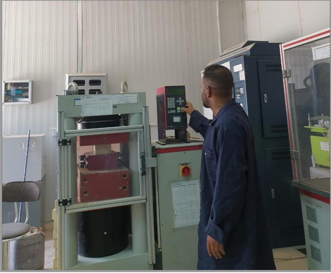
جهاز الانضغاط لفحص تحمل الطابوق
